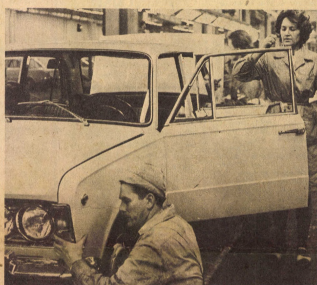
Az utolsó simítások. Nem tökéletes a lámpakeret, igazítani kell a szigetelésen, de hátul már csak a csomagtartó kimosása van hátra
